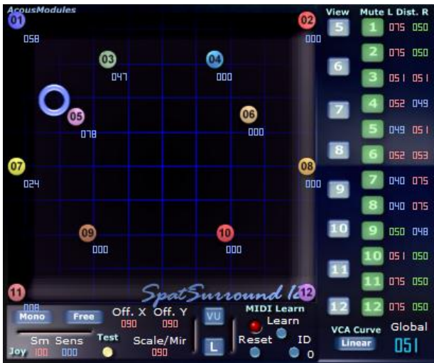
fig. 4 : SpatSurround 12 : le calcul des intensités se fait entre l'anneau bleu représentant la source sonore et les douze projecteurs numérotés, en fonction des réglages individuels d'atténuation (les valeurs dans les deux colonnes de droite).
