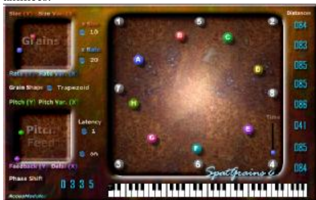
fig. 15 : SpatGrains 8 : les huit "grains" (billes de couleur, de "A" à "H") sont librement placés parmi les huit projecteurs (billes grises). L'ensemble des positions peut être changé par une note MIDI, instantanément ou selon une durée définissable.
