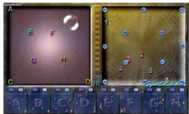
fig. 14 : SpatEdith 612 : les petits éditeurs graphiques en bas ("A" à "H", huit configurations par patch) permettent de définir différentes masses spatiales complexes (qui s'affichent sur la vue de droite). L'interpolation se réalise sur la vue de gauche : un seul geste et deux courbes suffisent ainsi pour faire évoluer la source hexaphonique...
