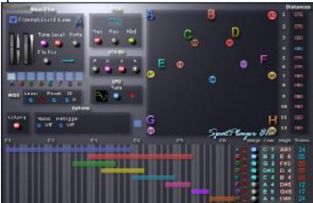
fig. 17 : SpatPlayer 812 : la sortie de chacune des huit zones d'échantillons peut être positionnée et jouée à partir de contrôleurs MIDI
