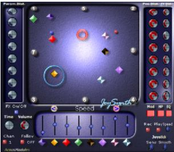
fig. 18 : JoySynth, le jeu se fait exclusivement à l'aide d'un Joystick standard ou d'une tablette graphique. Les deux anneaux (interpolation des paramètres de synthèse et
