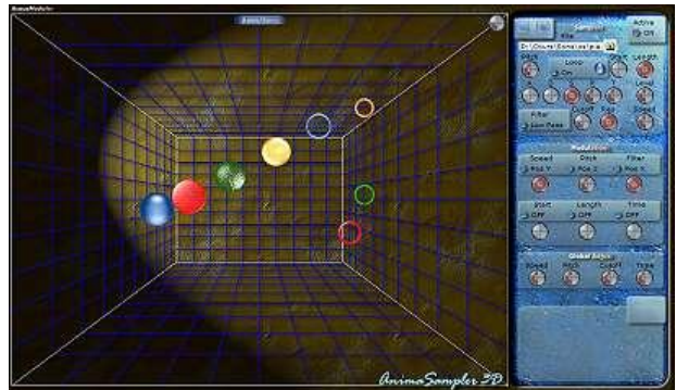
fig. 19 : AnimaSampler 3D, la position spatiale des huit échantillons, la hauteur spectrale, le filtrage et le bouclage sont déterminés par le jeu avec un Joystick 3D ainsi que par la combinaison de quelques modèles simples comme l'inertie, la dispersion ou la gravité.
